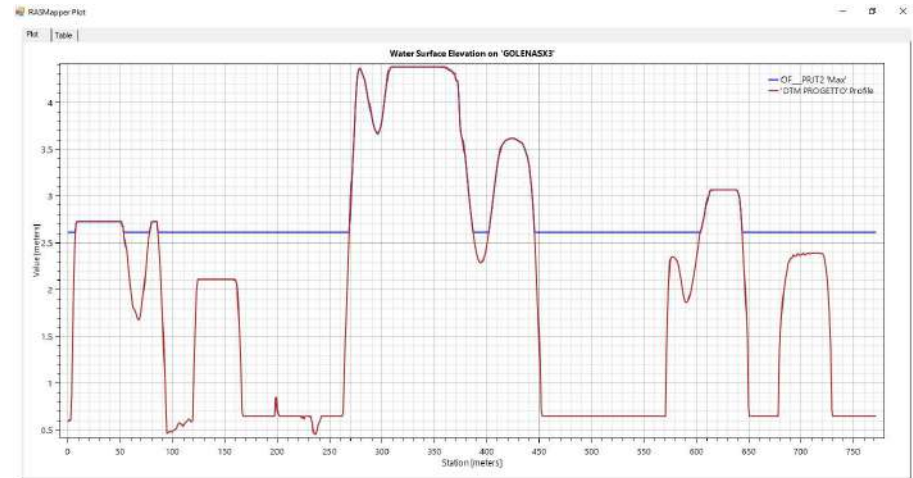
Fig. 18: WSE_{max} nella sezione di controllo 3 (golena sx) con Q_{T2} su DTM LiDAR esistente
